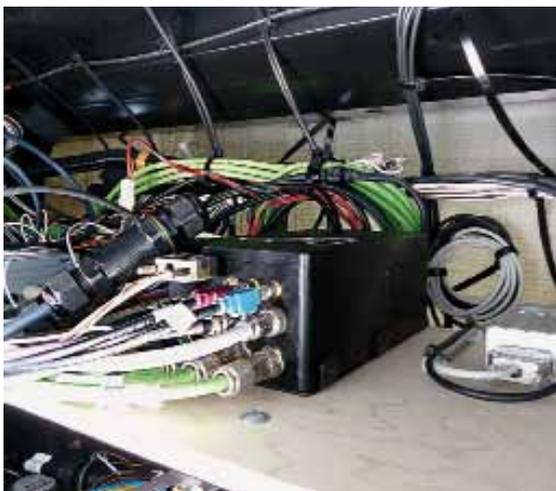
**Oberhalb des Fahrerplatzes wird ein speziell für Moby konstruierter Rechner eingebaut.**
